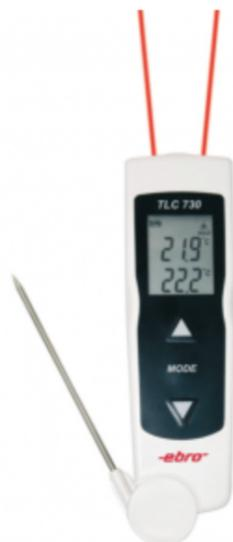
Удобный, водонепроницаемый ИК термометр с большим диапазоном измерения для бесконтактных измерений или измерения температуры поверхности, а также внутренней температуры при помощи складного погружного датчика. Для точного измерения температуры поступающих товаров, производства и хранения различных продуктов и пищи. Соответствует требованиям HACCP и DIN EN 13485. В комплекте поставки батарея и сертификат калибровки.
